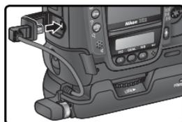
5 Pase el cable por la guía de la tapa del compartimento de la batería BL-2.
